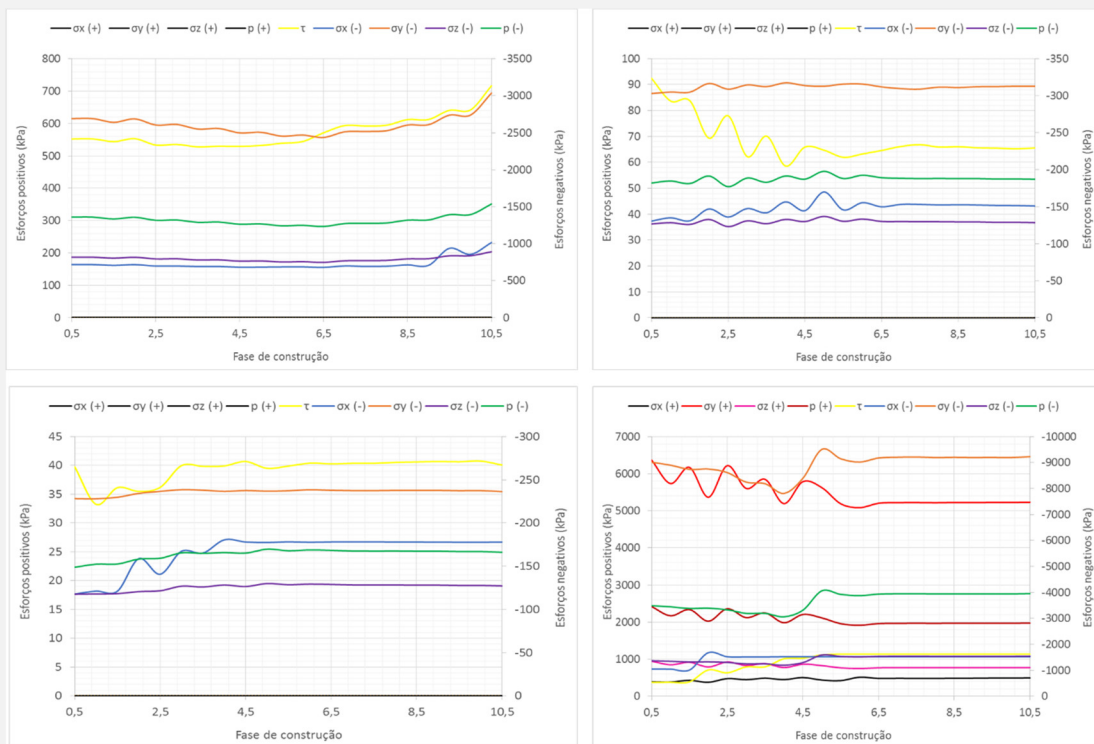
Figura 4.48 – Evolução das tensões máximas em cada zona do sistema: superior esq.) ZG1; superior dir.) ZG2; inferior esq.) ZG3; inferior dir.) Estacas
